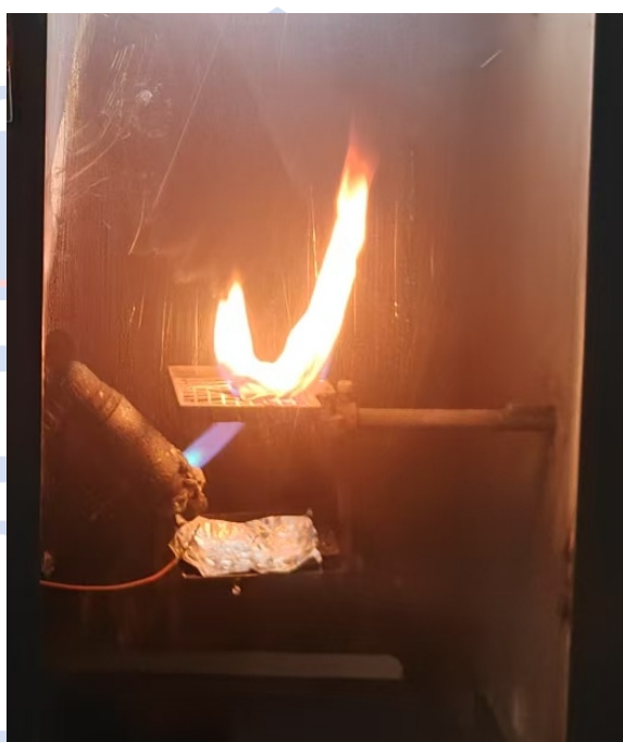
图 4 烟密度等级试验示意图
